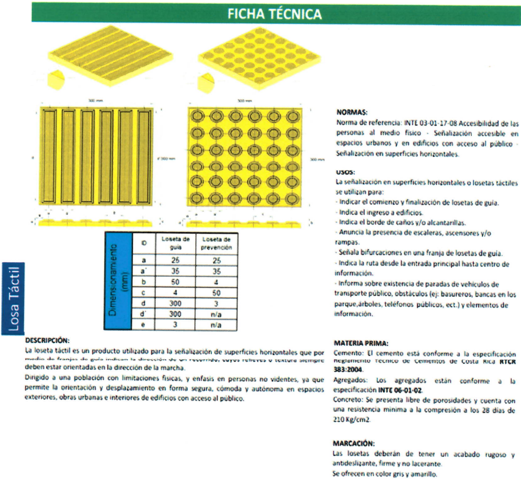
Imagen N° 3. Detalle Ficha Técnica Loseta Táctil.
